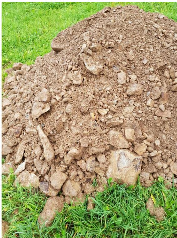
**Abbildung 7: Bodenschurf im westlichen Bereich des BPlanbereichs. Die Böden sind tiefgründig und wasserdurchlässig; rechts das Aushubmaterial**
